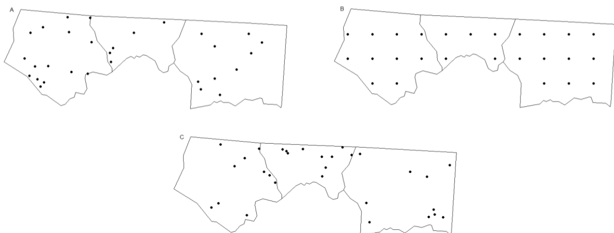
Figure 12-4. Exemples fictifs de modèles d'échantillonnage basés sur : A) l'échantillonnage aléatoire simple (30 points), B) l'échantillonnage aléatoire systématique et C) l'échantillonnage aléatoire stratifié (10 points par strates). Adapté de De Gruijter et al. (2006).
