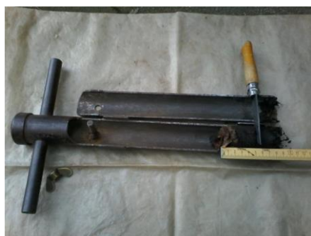
Figure 10-13. Gauche : carottier permettant l'extraction d'une carotte de sol ; droite : découpage par tronçons de 5 cm de la carotte de sol avant extraction des enchytréides
